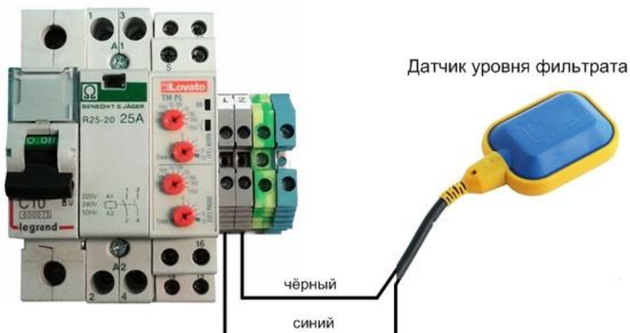
Рис. 4. Подключение датчика уровня к установке.
